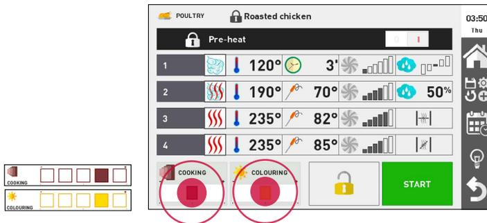
**IT** - Con la funzionalità Recipe Tuner è possibile selezionare a piacimento il livello di Cottura, Doratura, Umidità e Lievitazione. Una volta selezionato il livello desiderato, il forno regola autonomamente tutti i parametri di cottura necessari.
